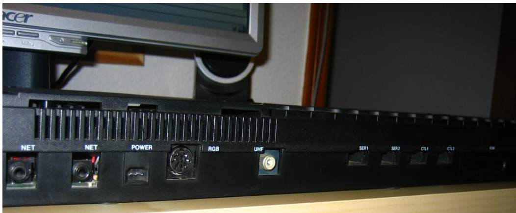
Vista posterior, puertos de expansión: Conectores de red, (alimentación), video (RGB y UHF) ,puertos serie, puertos joystick
